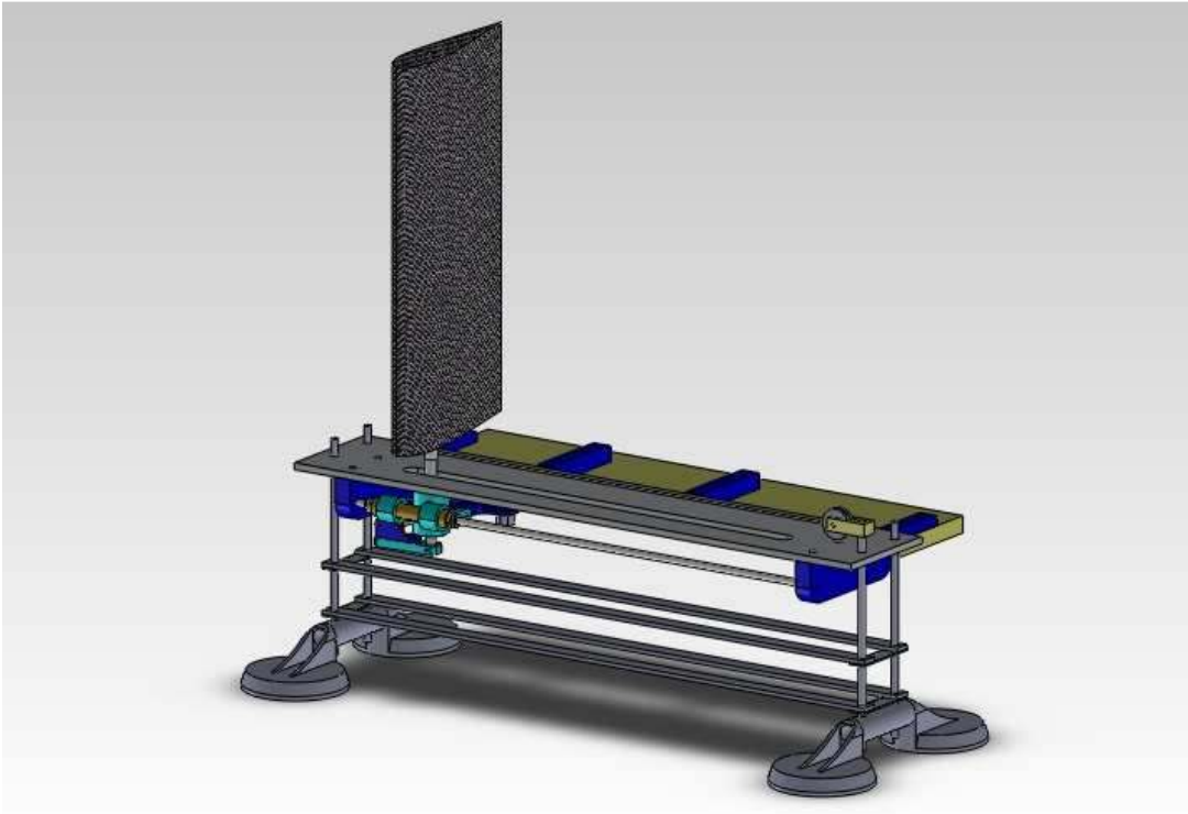
Şekil 5. Salınır kanat ve hareket mekanizmasından oluşan güç jeneratörü
