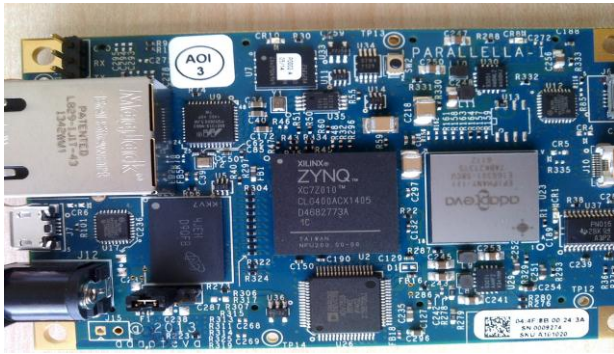
Şekil 2. Xilinx firmasının Zynq-7020 ve Adapteva firmasının Ephemany yongası kart üzerinde görülmektedir.
