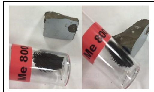
Ek C1: 800 °C'de sentezlenen malzemenin mıknatıslanması.
